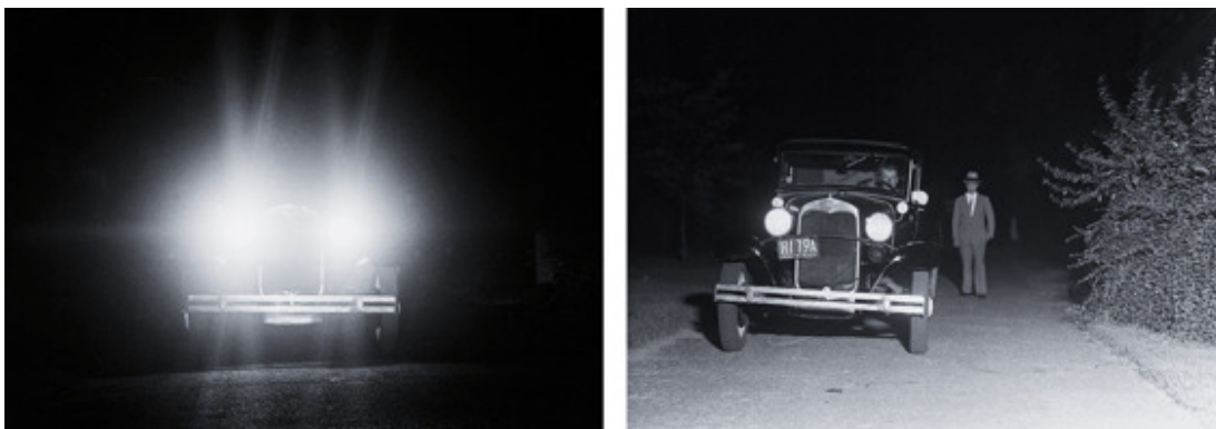
Faróis vistos através de vidro não polarizado e do vidro polarizado de Land
